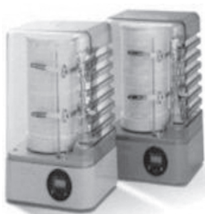
Gambar 9.7 Rain Gauge alat untuk mengukur curah hujan. Sumber: www.image.google.com
