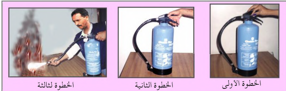
شكل (٢) خطوات استخدام طفاية الحريق
