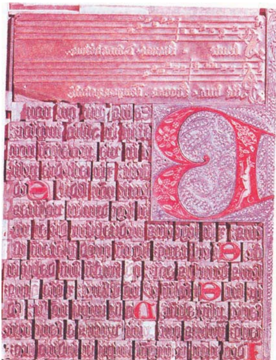
قالب يتضمن الحروف المعدنية التي اخترعها غوتنبرغ (حوالي 1455)
